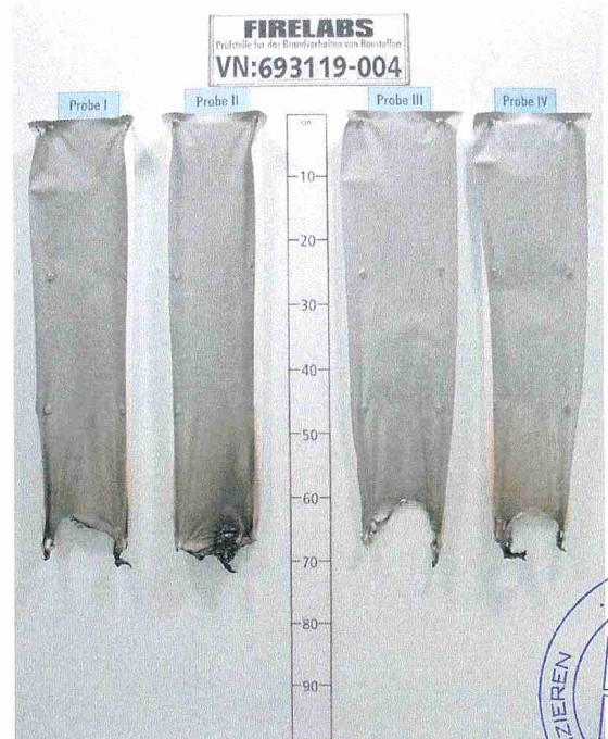
Bild 8 Aussehen des Probekörpers nach dem Brandversuch
