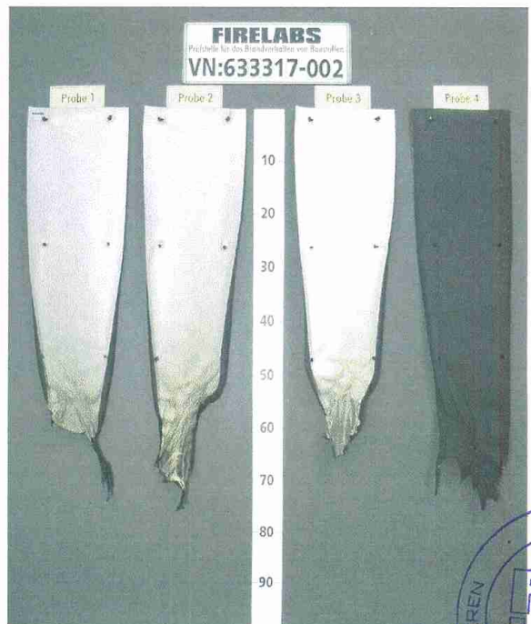
Bild 4 Aussehen des Probekörpers nach dem Brandversuch (Probe 4: Rückseite)
